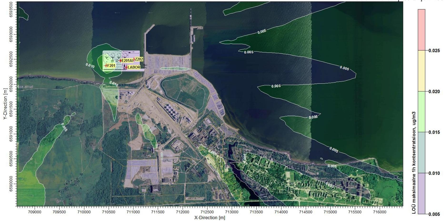
**Рисунок 11.** Среднечасовая концентрация летучих органических веществ, если работают все источники загрязнения от обработки LNG
