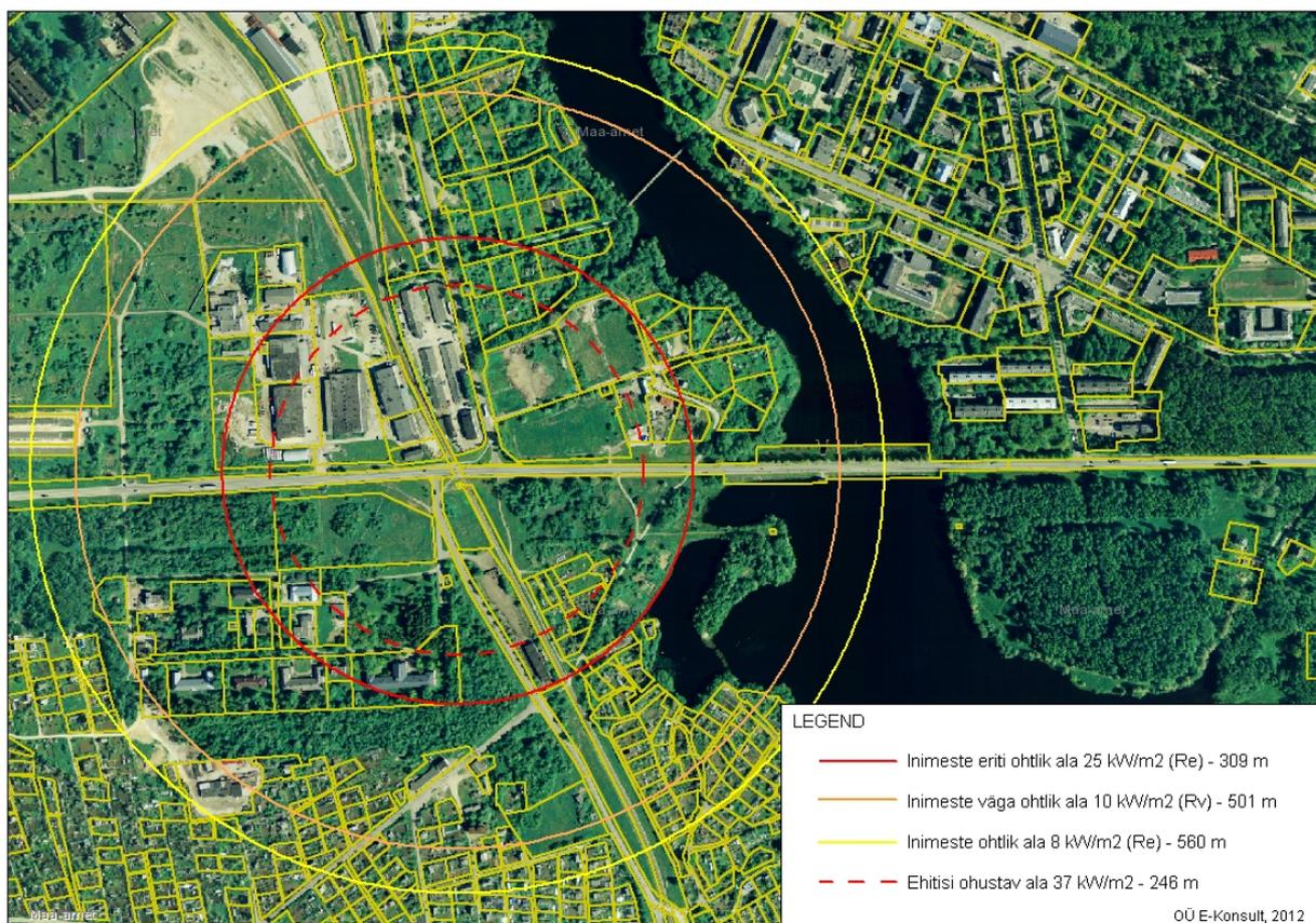
**Рисунок 33.** Опасная зона на перекрестке шоссе Таллинн - Нарва и железной дороги
