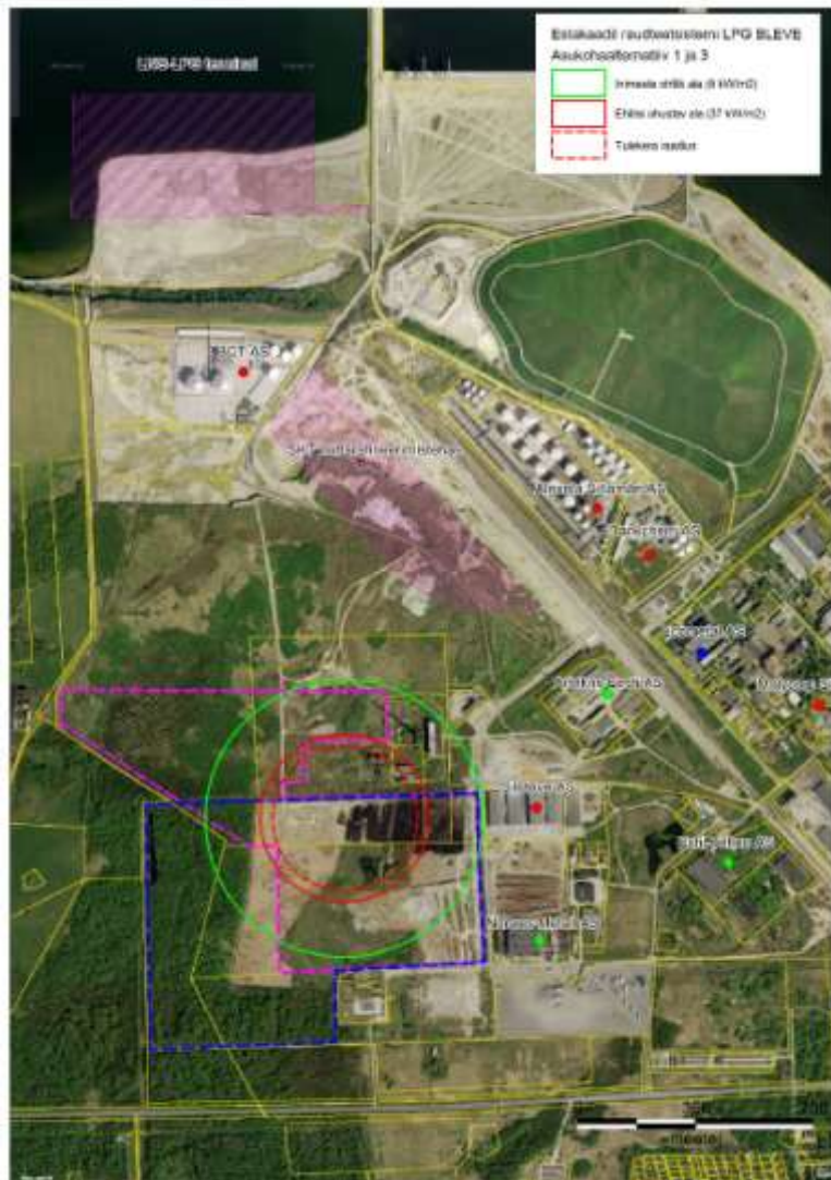
Joonis 59. LPG tsisterni BLEVE (alternatiiv 1 ja 3)
