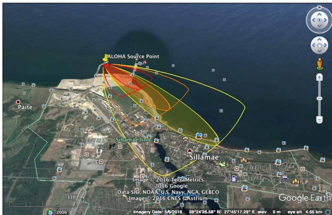
Joonis 7. Laevade lastimiskohas lekkinud ammoniaagi ohuala inimestele (loode tuule korral).
