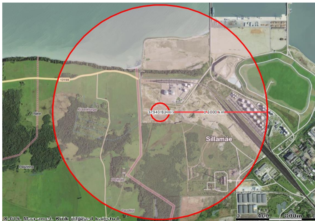
Joonis 2. Raudtee-estakaadil lekkinud/süttinud ammoniaagi ohualad.
