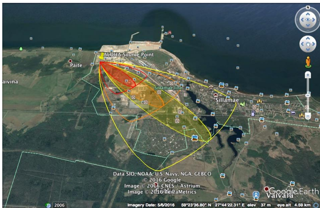
Joonis 5. Produktitoru purunemisel lekkinud ammoniaagi ohuala inimestele (loode tuule korral).
